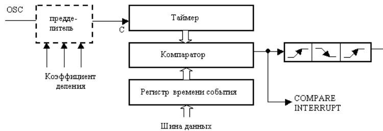
Рис. 15: Структурная схема модуля во выходном режиме (Compare)
